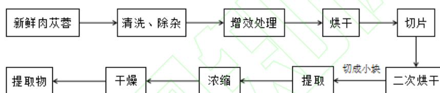
图 1 水提物试验工艺流程
